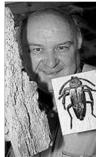
Ursache und Wirkung: der Hausbock und seine Fraßgänge.
